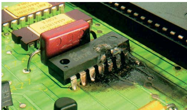
因电涌而受损的电子部件
